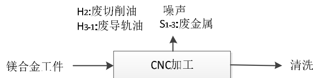
图 4.2-3 CNC 加工工段工艺流程图
